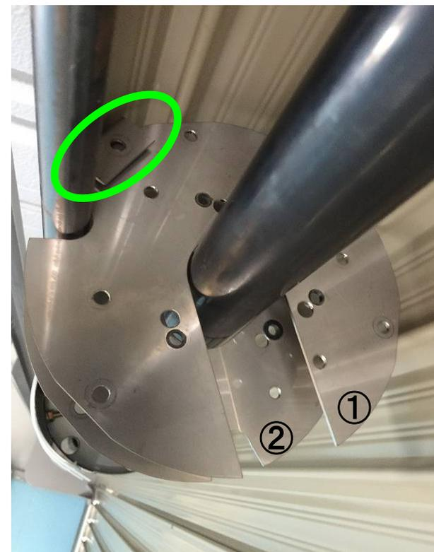
プーリープレート、プーリーブラケットの取り付け状況に合わせて、下の画像の様に固定用ネジ穴位置、プーリーブラケットの高さ調整をしてください。
